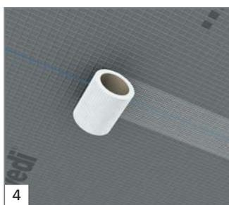
4 На стыки строительных плит наносится самоклеющаяся армирующая лента wedi *Tools*.
