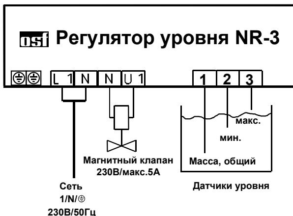
Кабель датчиков уровня можно удлинить экранированным проводом ( $2 \times 0,75\text{мм}^2$ ) до 50 м. Непременно прокладывайте проводку водоустойчиво. Избегать прокладку кабеля датчиков в близи с силовыми кабелями из-за возможных наводящихся помех.
