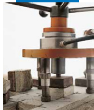
Испытание на адгезию SATTEC
