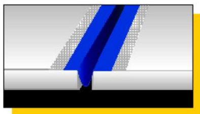
лента MAPEBAND 75 мм x 50 м для герметизации деформационных швов
