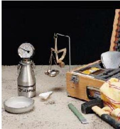
карбидный гигрометр для измерения влажности стяжек МАРЕСЕМ
