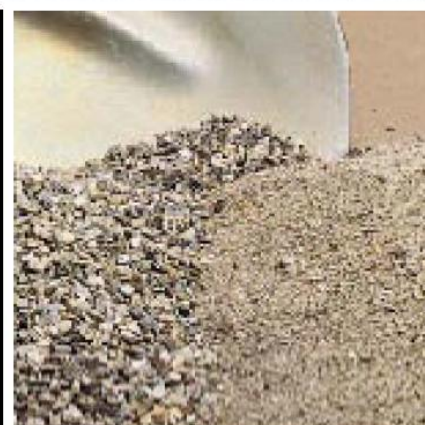
наполнители для МАРЕСЕМ : гравий диаметром 4-8 мм и песок диаметром 0-4 мм
