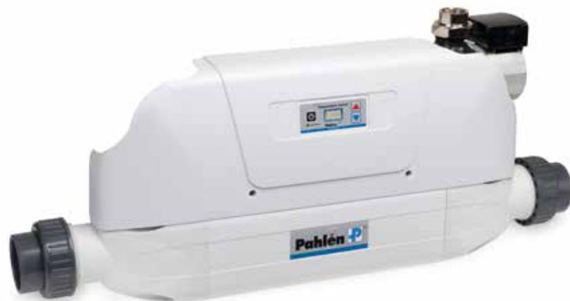
**Aqua MEX в комплекте** - комплект имеет встроенный трехступенчатый циркуляционный насос (однофазный) для первичного контура (горячая вода), встроенные датчики температуры и потока, обратный клапан, а также цифровой термостат со светодиодным дисплеем.
