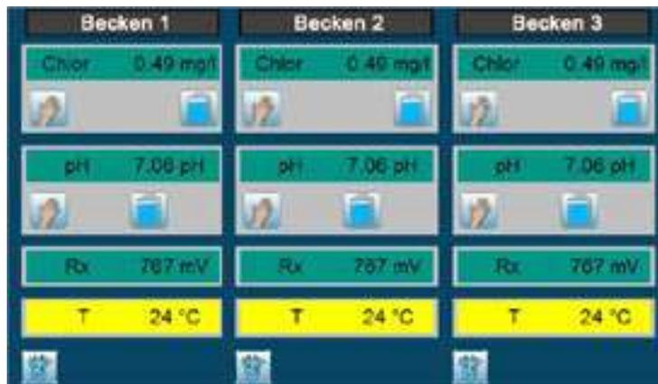
Для диспетчеризации и управления измерительно-регулирующими и дозирующими системами и электролизными установками с преобразователем интерфейсов для ОС Windows (ПО, преобразователь USB/RS485 и кабель).
