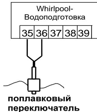
Поплавковый мини- переключатель монтируется на подвижном уголке, который затем прикручивается на желаемой высоте к крепежной планке вертикально закрепленной на стенке скиммера. Перемещая уголок вдоль крепежной планки можно выставить необходимый уровень воды. Фиксируется уголок с помощью крепежного болта. Все части очень хорошо подходят друг к другу, так что нет необходимости применения силы.
