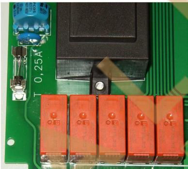
Электронная часть защищена плавким предохранителем (0,25А) находящимся на монтажной плате блока управления. Так как блок управления не предохраняет фильтрационный насос от короткого замыкания, то необходимо предварительно установить защитное устройство с током срабатывания не более 16А.
