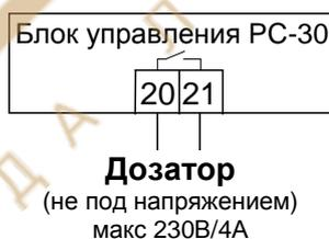
Между клеммами 20 и 21 внутри блока управления находятся нормально разомкнутые свободные от напряжения контакты реле, которые например: можно использовать для управления дозирующей техникой (во время фильтрации эти контакты замкнуты).
