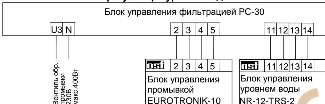
К клеммам U3 и N можно подключить гидроклапан (230В) для обратной промывки.
