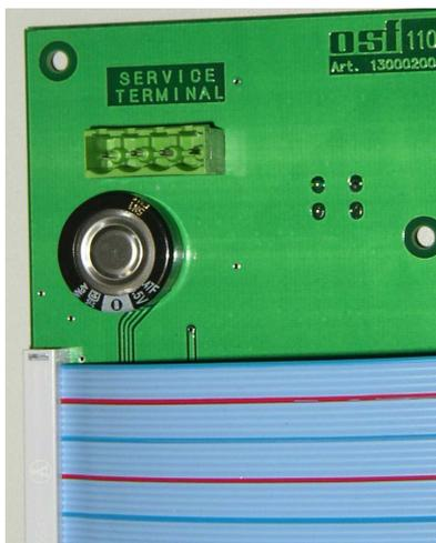
Для оптимальной адаптации блока управления к различному оборудованию, а также для облегчения ввода в эксплуатацию и последующего обслуживания можно к блоку управления подключать osf-Service-Terminal (Арт. N.3010000900). Соответствующий разъем находится на внутренней стороне монтажной платы лицевой панели.
