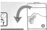
Этот индикатор светится, если проводится обратная или чистовая промывка с помощью гидроклапанов.
