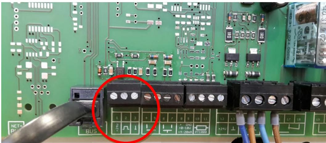
Вход (2+3) на панели управления MBO - Control может также использоваться с M.EC 40 / 80 direct для дезинфекции второго бассейна.
