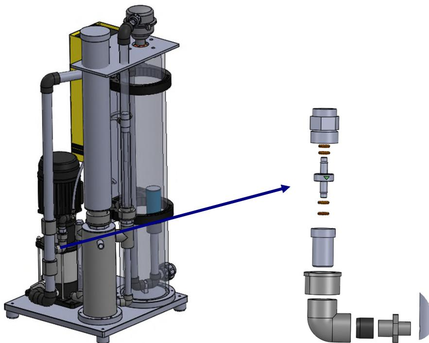
**ВНИМАНИЕ:** Обслуживание: Ежегодно следует проверять обратный клапан, при появлении водяных капель в прозрачной трубке из PTFE заменить его на новый.
