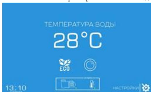
Рис. 5.2 Главный экран при режиме всех переключателей «О – Выкл.» блока управления
