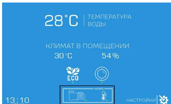
Внимание: при неработающем насосе фильтрации температура воды не отображается (см. рис. 6).
