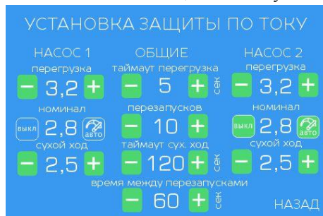
Рис. 11 Установка защиты по току
