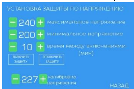
Рис. 12 Установка защиты по напряжению
