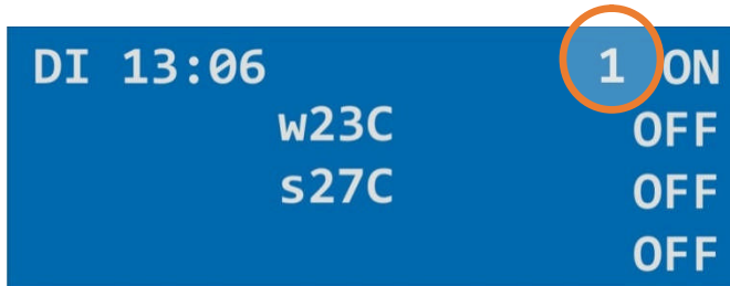
Рис. 2. Дисплей с актуальными значениями Значение 1 в желтом круге означает актуальную скорость насоса.
