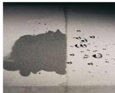
Этот кусок камня pietra Serena был наполовину обработан средствами Fila, а наполовину - нет. На обработанной части, справа, можно заметить характерный эффект образования водяных капель. На необработанной части вода проникает в пол.
