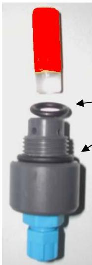
При очистке ячейки контролировать наличие двух уплотнительных колец.
