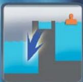
Schwallwasserbehältersteuerung für Becken mit Überlaufrinne. Mit hydrostatischer Messwerterfassung der Niveauhöhe.
