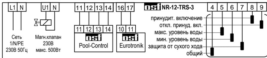
На примере показан вариант подключения с блоками управления фильтрацией серии Pool-Control от компании **osí**.
